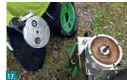
17. Förderpumpe wieder zusammenbauen.
