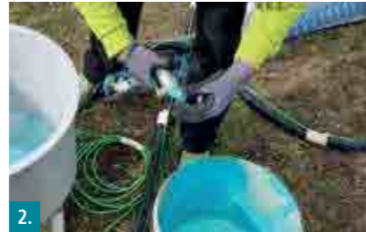
2. Düse vom Spritzkopf entfernen.
