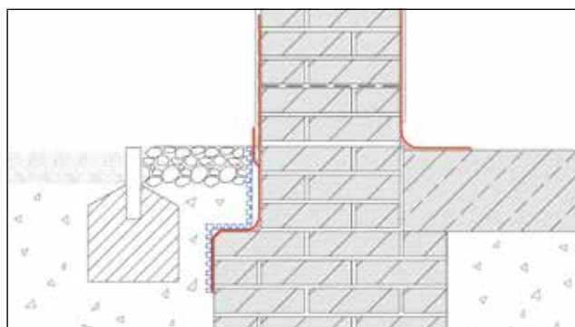
Einschaliges Mauerwerk, feuchte- und salzbelastet
