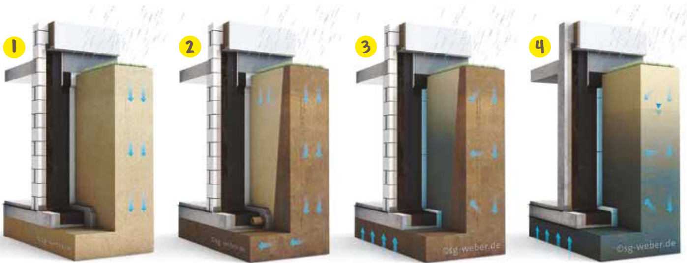
1 Lastfall Bodenfeuchte DIN 18 195-4
